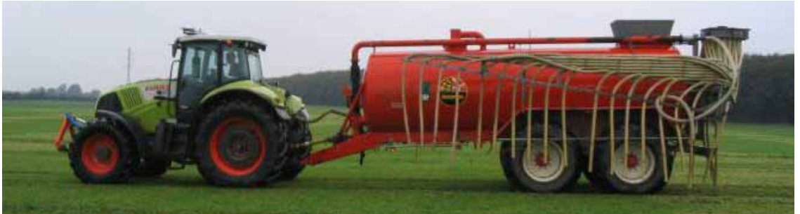
Foto 1. En Claas Axion traktor, udstyret med RTK-GPS autostyring og en 15 m 3 2-akslet Kimadan gyllevogn blev brugt i forsøgene. Fotoet viser den anvendte maskinkombination.
